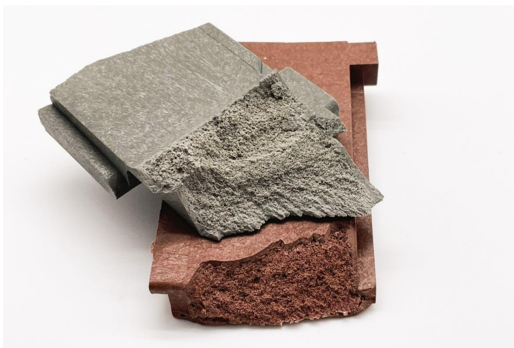
Zdjęcie 2: Lekkie, stabilne, zrównoważone: przekrój doskonale spienionych komponentów wykonanych w 100% z recyklatów postkonsumenckich o masie mniejszej o 30 procent przy 10-procentowym zwiększeniu wytrzymałości na uderzenia.
