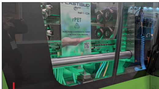
Ce moule bi-étage Plastisud peut produire 8 300 pots/h de 125 ml.
