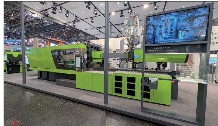
La presse Engel tout-électrique e-Motion 420 t était associée à un robot Pagès pour la dépose des étiquettes.
