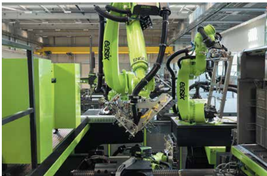
Рис. 2. Коммуникация между литьевыми машинами и роботами представляет собой особую проблему, поскольку информация об их движениях должна передаваться мгновенно – в режиме реального времени
