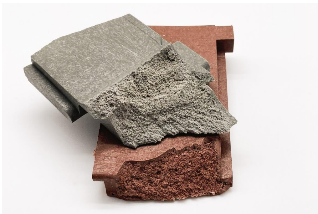
Figura 2: Leggero, stabile, sostenibile : Sezione trasversale del componente espanso realizzato al 100% in materiale riciclato da post-consumo, con una riduzione del peso del 30% e una resistenza all'urto superiore del 10%.
