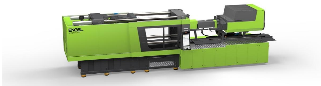
Rysunek 6: Na całkowicie elektrycznej wtryskarce ENGEL e-motion 420, cienkościenne kubki zawierające 30% rPET powstają w ramach produkcji seryjnej z wykorzystaniem formy piętrowej – zgodnie z dyrektywą w sprawie opakowań i odpadów opakowaniowych 2030.
