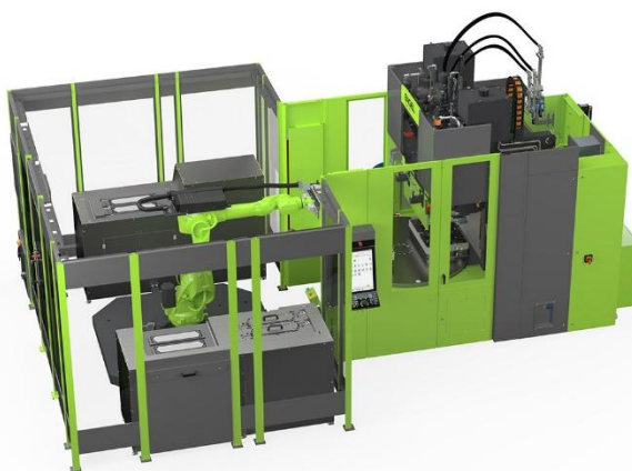
Rys. 2: Precyzyjne uszczelki LSR do ogniw paliwowych produkowane są na pionowych wkładkach ENGEL 150 – w ramach całkowicie zautomatyzowanego obtrysku zaprasek z maksymalną dokładnością na minimalnej przestrzeni.
