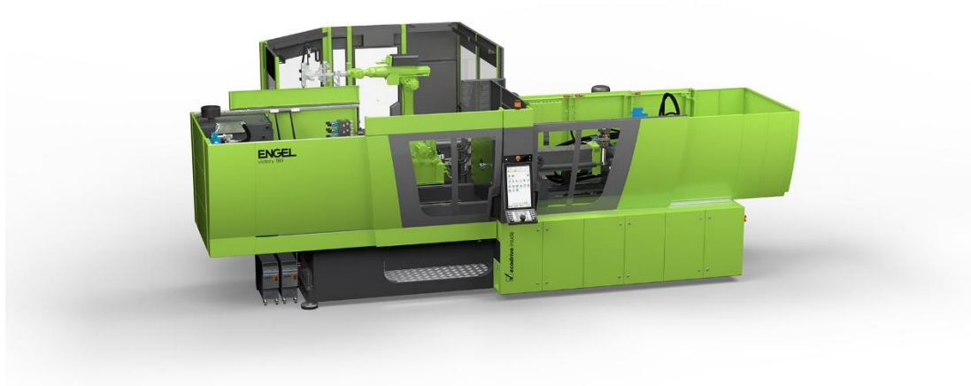
Rys. 3: Wytrzymała kierownica rowerowa produkowana na bezkolumnowej wtryskarce ENGEL victory 180 – lekka, zautomatyzowana produkcja ze stałym wzmocnieniem włókien w technologii fluidmelt i organomelt.
