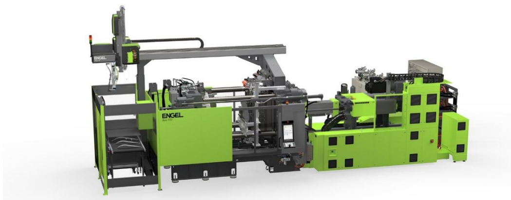
Rys. 1: Funkcjonalne lampy tylne produkowane na wtryskarce ENGEL duo 700 – z wysoką precyzją i wykorzystaniem technologii clearmelt i foilmelt w ramach jednego, zintegrowanego procesu na bardzo niewielkiej przestrzeni.
