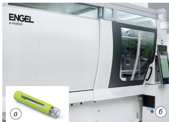
**Рис. 2.** Толстостенная корпусная деталь медицинского назначения (а) требует значительно более короткого времени цикла при ее двухкомпонентном литье, которое на выставке «К-2019» будет «вживую» проводиться на полностью электрической машине e-motion 310H/170W/160 combi в исполнении для чистого помещения (б)
