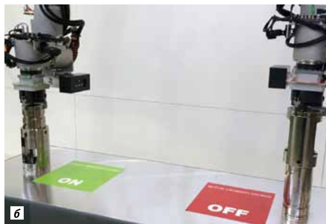
Один из двух роботов ENGEL viper 40 работал на выставке Fakuma-2015 с применением системы компенсации вибраций active vibration control, а другой – без нее. Робот с активированной системой, одновременно начинавший работу со вторым роботом (а), значительно раньше достигал стабильного крайнего положения (б) и мог выполнять свою задачу по перемещению изделия за более короткое время, чем робот с дезактивированной системой
