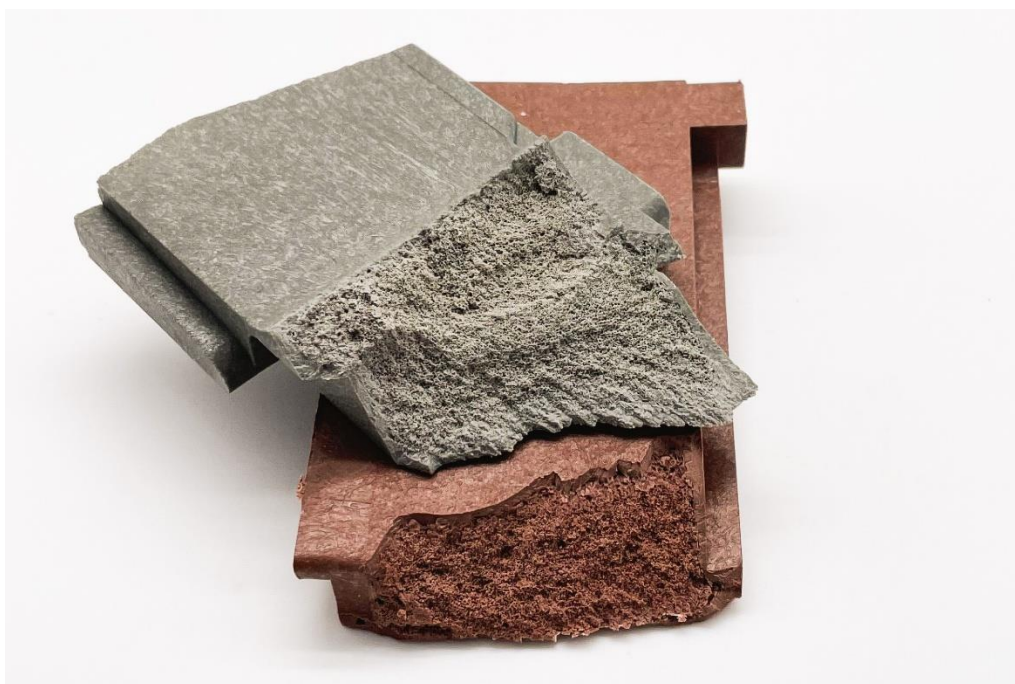
Imagen 2: Ligero, estable y sostenible: sección transversal de un componente perfectamente espumado fabricado con material postconsumo 100% reciclado. Su peso es un 30% menor y su resistencia al impacto, un 10% mayor.
