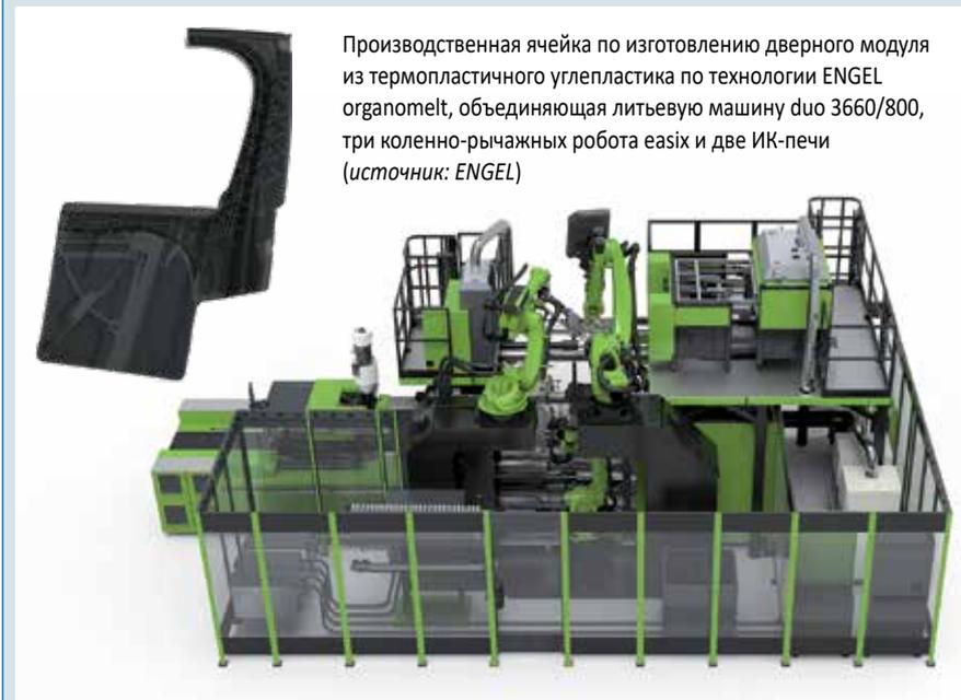
Производственная ячейка по изготовлению дверного модуля из термопластичного углепластика по технологии ENGEL organomelt, объединяющая литьевую машину duo 3660/800, три коленно-рычажных робота easix и две ИК-печи (источник: ENGEL)
