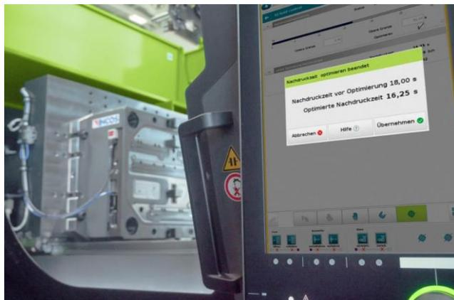
Souvent, le temps de postpression optimal déterminé automatiquement est inférieur à celui défini au départ. Dans ces cas, le temps de cycle se voit réduit.
