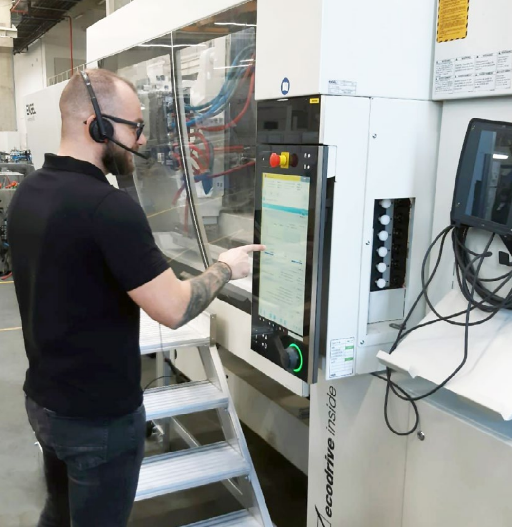
轴承支架在 ENGEL e-victory 400 注塑机上通过 MuCell 泡沫注塑工艺生产。
