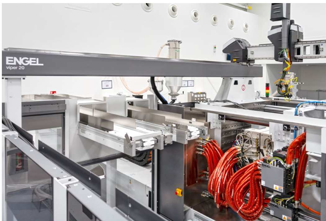
viper 20 机械手执行两项任务：将注塑部件从模具中脱模以及将冷却零件从补充冷却段移至输出传送带。
