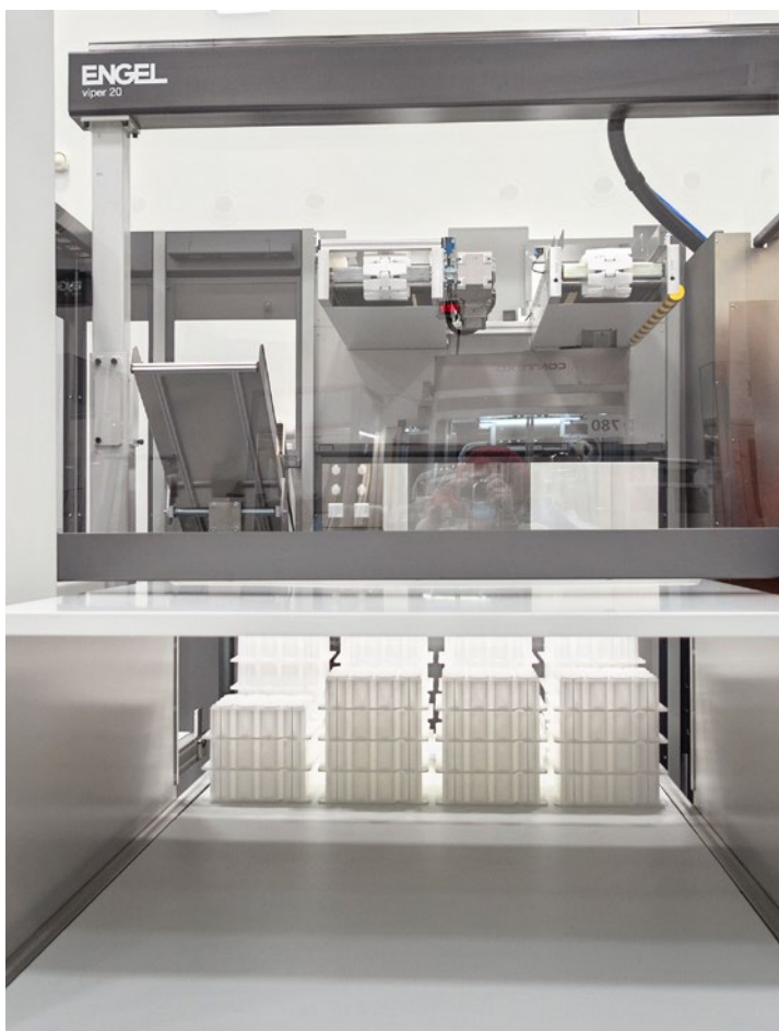
得益于补充冷却段, POM 嵌套插件可以直接堆叠。viper 机械手将其拾起并通过较大的下方传送带传送。
