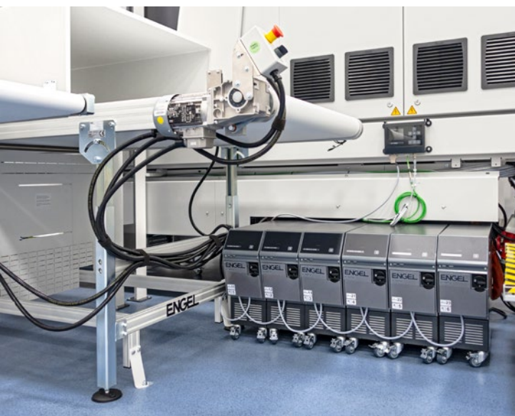
使用 e-temp 温控设备显著提高了温控过程的能效。通过 OPC UA 与 CC300 机器控制系统连接, 温控设备根据需求调整其泵速。
