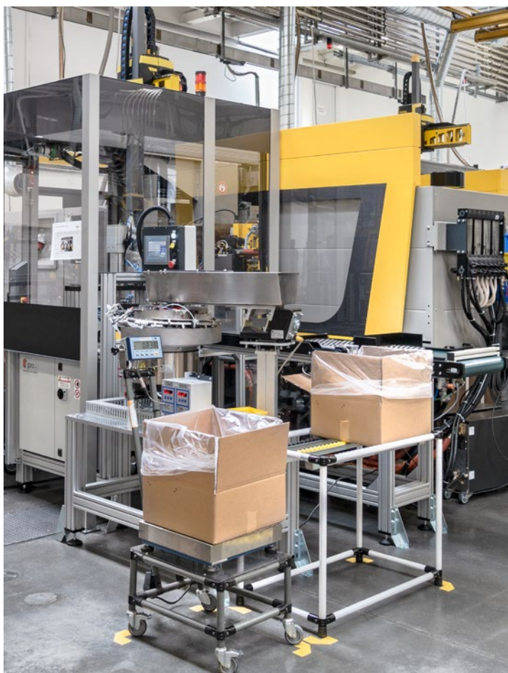
Für den neuen Produktionsprozess investierte Interroll in eine integrierte Fertigungszelle mit einer ENGEL victory 120 Spritzgießmaschine und einem ENGEL viper 12 Linearroboter.
