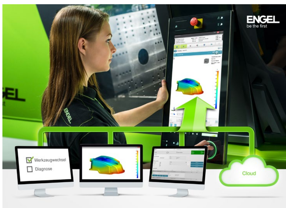
Der Webviewer in der Maschinensteuerung integriert nicht nur Peripheriegeräte mit Webinterfaces, sondern auch Daten aus internen und externen Systemen, die via Browser zugänglich sind.
