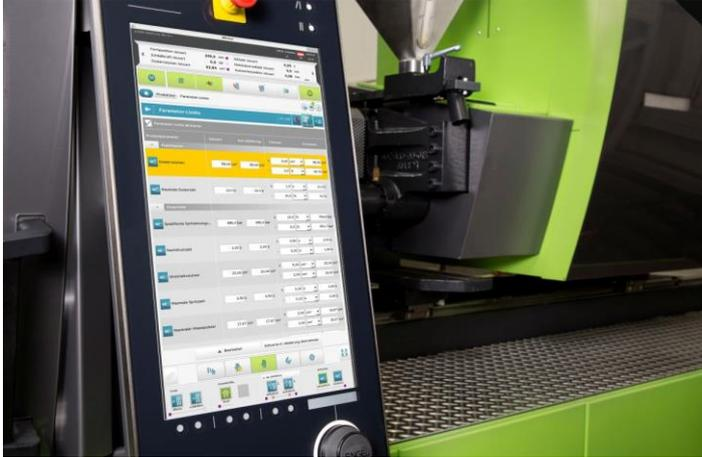
Con la nueva función Parameter-Limits se pueden ajustar directamente los rangos de tolerancia de hasta 150 parámetros de procesos en el mando de la máquina.
