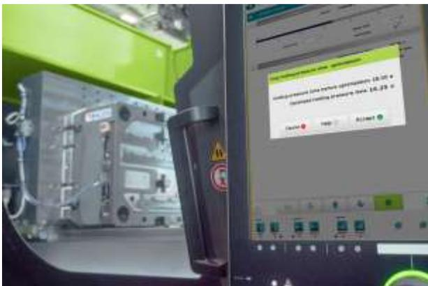
Das neue Assistenzsystem iQ hold control ermittelt die optimale Nachdruckzeit und sorgt damit für mehr Effizienz sowohl beim Rüsten als auch in der laufenden Produktion.
