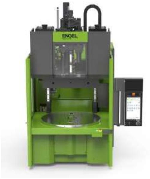
Die ENGEL insert Vertikalmaschine bietet viel Flexibilität für Einlegeprozesse.
