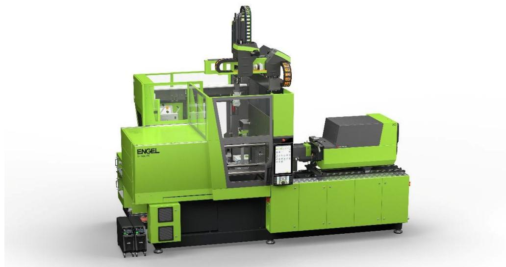
**Qualitätsregelung mit weniger Material- & Energieverbrauch:** Die kompakte autonome Spritzgießzelle von ENGEL mit einer vollelektrischen e-mac 80 Spritzgießmaschine, ENGEL compact cell Automatisierung und Inline-Qualitätserfassung im Zentrum.
