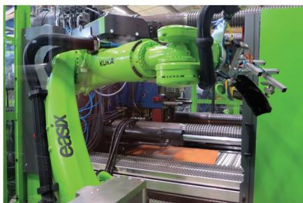
Фото 1. Коленно-рычажный робот ENGEL easix делает производственные ячейки максимально компактными (все фото: ENGEL)
