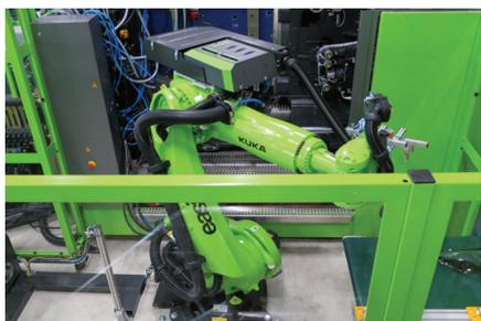
**Фото 3.** Программируемые зоны блокировки движений робота и надежный контроль его рабочих зон позволяют приблизить защитное ограждение максимально близко к роботу и тем самым еще более уменьшить занимаемую производственной ячейкой площадь
