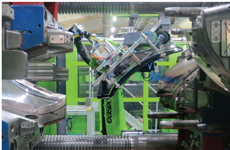
Прецизионная работа: на минимальной площади коленно-рычажный робот ENGEL easix бережно извлекает чувствительные к механическим воздействиям элементы автомобильной оптики из сложной литьевой формы
