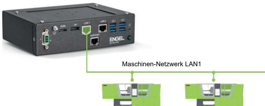
Bei einer Netzwerk trennung dient der Netzwerkanschluss **LAN3** am EDGE Device zur Kommunikation mit den ENGEL Endpunkten. Dafür wird eine Internetverbindung benötigt (eventuell Office-Netzwerk). Die IP-Adresse für **LAN3** kann sowohl dynamisch als auch statisch konfiguriert werden. Bei der Verwendung ohne Netzwerk trennung wird über **LAN3** sowohl die Verbindung zu den ENGEL Endpunkten, als auch die Verbindung zu den Maschinen hergestellt.
