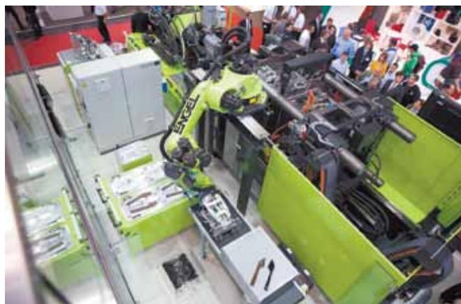
*Фото 1. Пример полной интеграции промышленных роботов в большие литьевые машины на выставке Fakuma-2015 (13–17.10.2015, г. Фридрихсхафен, Германия), где на машине ENGEL duo combi M изготавливались декоративные элементы для интерьера автомобилей. При этом многоосевой робот easix выполнял все необходимые манипуляции с заготовками из натуральной древесины и готовыми изделиями (фото: ENGEL)*
