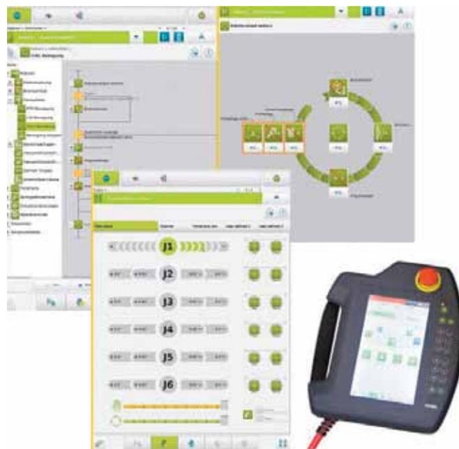
Рис. 2. Полное совмещение систем управления машин и роботов обуславливает возможность простого параметрирования и обслуживания многоосевых роботов easix. Технические решения компании ENGEL позволяют осуществлять объектно-ориентированное графическое построение последовательности технологических операций, причем для этой цели вполне достаточно располагать навыками управления линейными роботами (рисунок: ENGEL)
