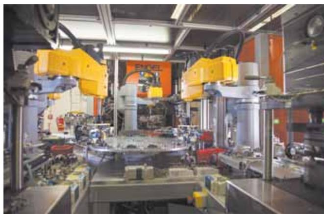
Фото 3. За счет новых роботов Scara компания ENGEL в очередной раз расширила свою серию роботов easix. Они применяются для быстрого выполнения задач по подъему и перемещению изделий, включая эффективную предварительную загрузку захватов или приемно-накопительных устройств (фото: ENGEL)
