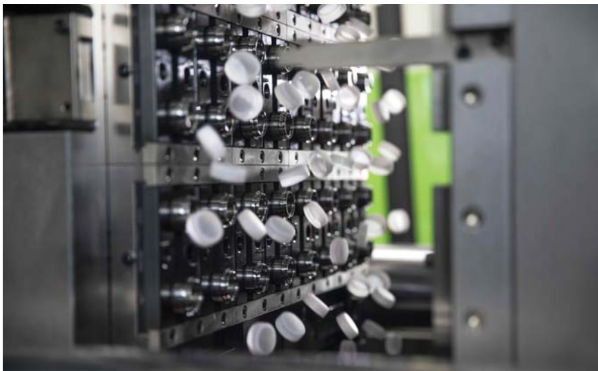
Скоростной термопластавтомат для производства крышек ENGEL e-cap
