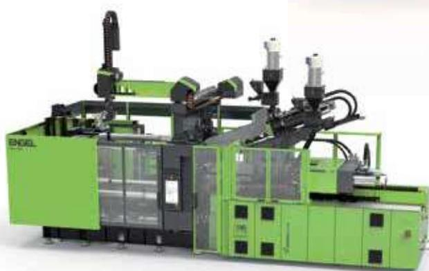
Il sistema di filtrazione e degassaggio è installato tra le unità di plastificazione e iniezione (foto Engel)
