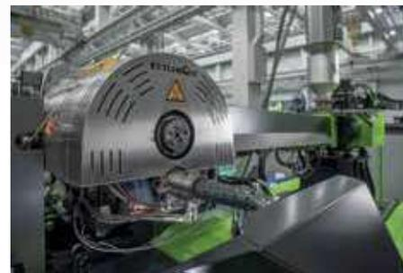
Nel processo skinmelt, l'unità di iniezione secondaria, dove viene plastificato il materiale della pelle, è montata in configurazione W sopra l'unità di iniezione orizzontale dedicata alla fusione del riciclati (foto Engel)
