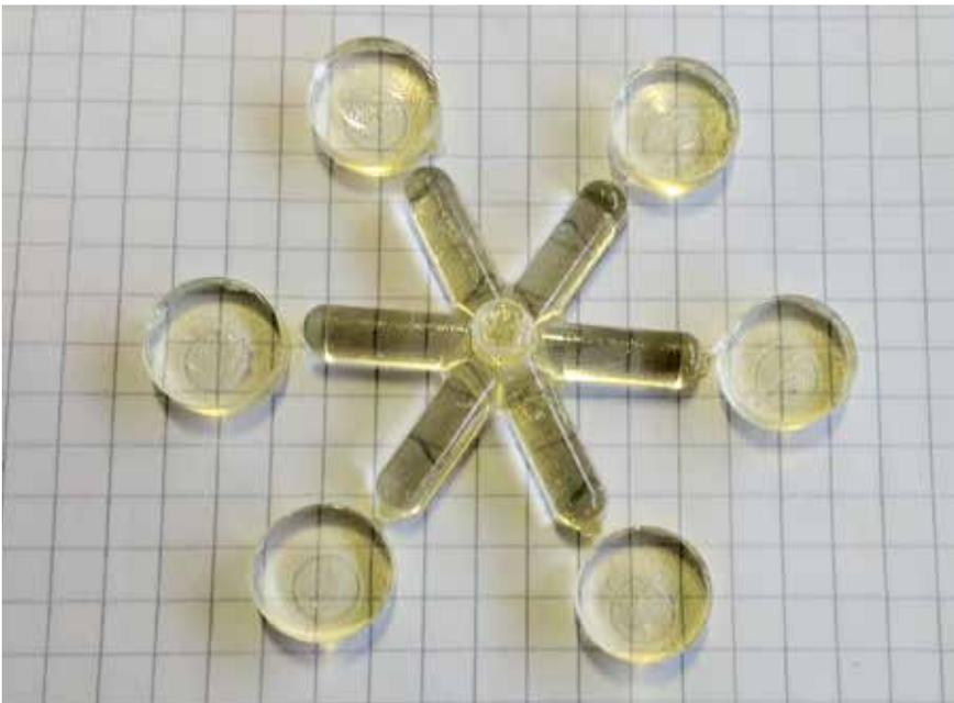
Die Tabletten (hier mit Angussverteiler, aber ohne Stangenanguss) wurden aus Soluplus-Pellets mit 10 %-igem Wirkstoffanteil (Fenofibrat) im Einstufenprozess hergestellt
