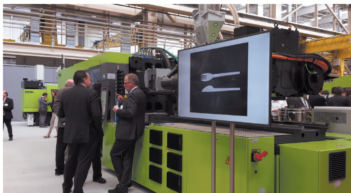
Фото 16. Производствен- ный комплекс на базе полностью электрической машины e-motion 2440/380 для изготовления комплектов пластиковых ножей и вилок
