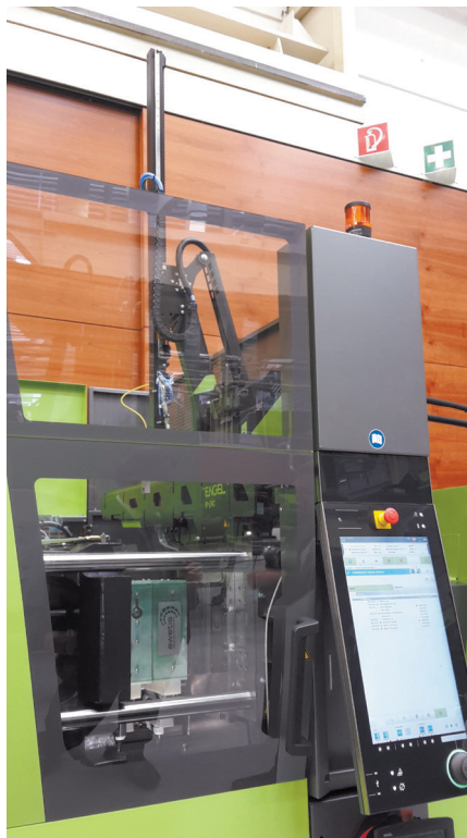
Фото 9. Зона формы горизонтальной машины e-мас 50/50 с установленным над ней новым роботом модели e-ріс для автоматического съема деталей. Робот компактно расположен внутри ограждения машины и не требует дополнительной производственной площади
