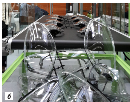
Фото 11. Литьевый комплекс на базе duo 1500 combi M и робота viper 120 (а) для производства рассеивателей фар (б)
