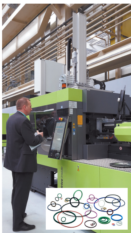
Фото 8. Новая горизонтальная гидравлическая машина flexseal 300 T, предназначенная для литья разнообразных уплотнений
