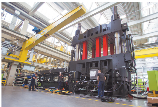
Фото 12. Вертикальная машина с самым большим усилием сжатия (36 000 кН) в серии v-duo в процессе монтажа на заводе в Санкт-Петербурге (фото: ENGEL))
