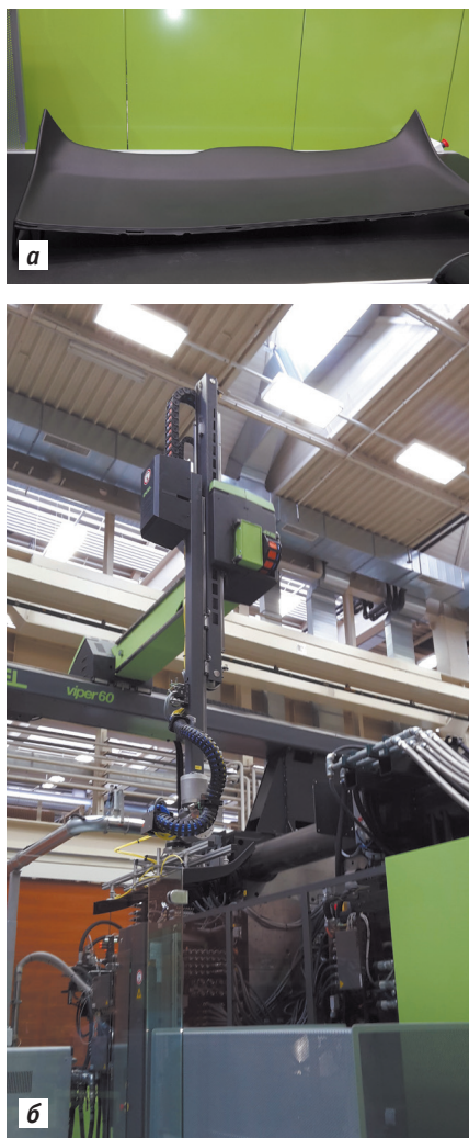
Фото 10. Автоматический съем и укладку на транспортер крупногабаритного элемента багажника автомобиля (а) осуществляет линейный робот viper 60, установленный на горизонтальной машине duo 11050/1700 (б)
