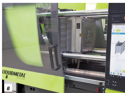
Фото 20. Устройства для автоматической загрузки и ориентации металлических заготовок (а), индукционное нагревательное устройство (б) и зона формы литьевой машины e-motion 110, модернизированной для реализации технологии Liquidmetal (в) (фото: ENGEL)
