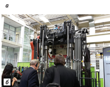
Фото 13. Общая компоновка производственного комплекса (а) на базе вертикальной машины v-duo 3550/1100 (б) для изготовления изделий из полиуретанового стеклопластика (в)
