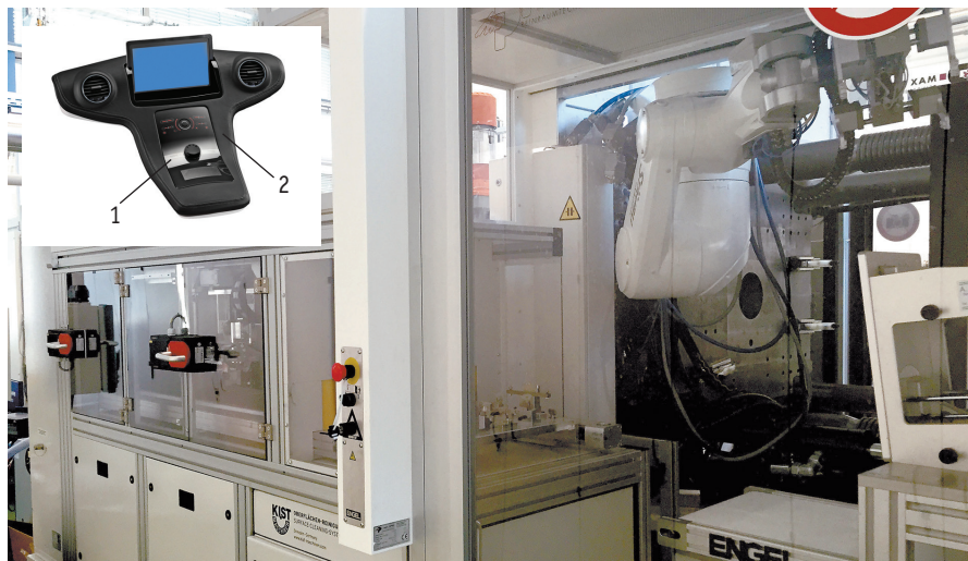
Фото 18. Многоосевой робот easix, подвешенный «вниз головой» и не требующий тем самым дополнительной установочной площади в комплексе на основе машины duo 1800/400, за один цикл литья закладывает две емкостные пленки в форму (на позиции закладки) и сразу же (на позиции съема) извлекает готовое изделие – сенсорный пульт управления (1) приборной панели (2) (фото: ENGEL)
