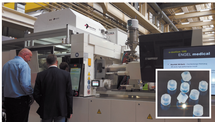
Фото 14. Литьевая машина e-motion 440/160 для изготовления иглодержателей из ПП с произво- дительностью около 90 тыс. шт. в час
