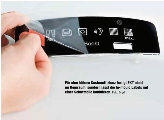
**Für eine höhere Kosteneffizienz fertigt EKT nicht im Reinraum, sondern lässt die In-mould Labels mit einer Schutzfolie laminieren.** Foto: Engel
