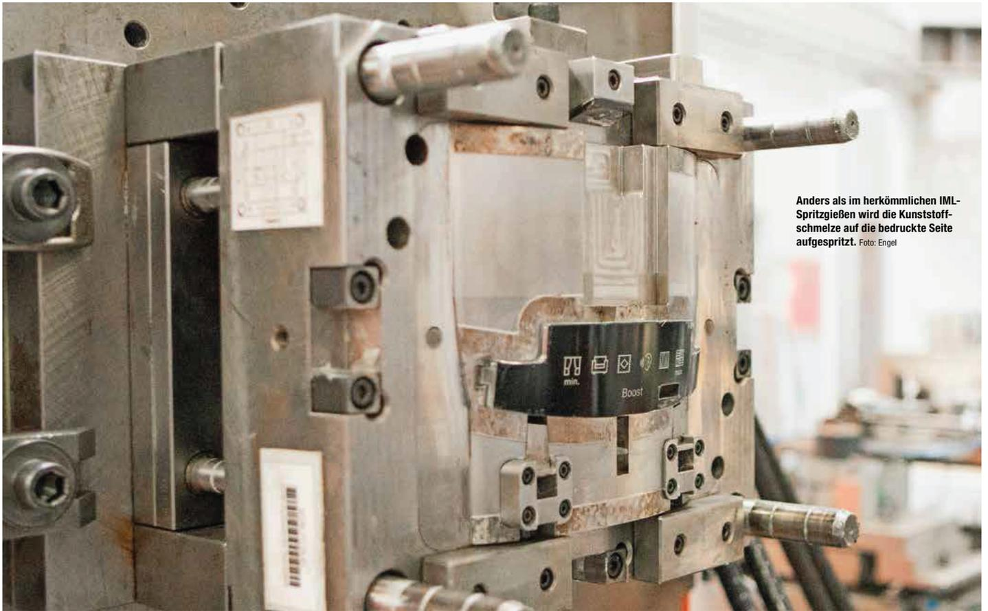
Anders als im herkömmlichen IML-Spritzgießen wird die Kunststoffschmelze auf die bedruckte Seite aufgespritzt. Foto: Engel
