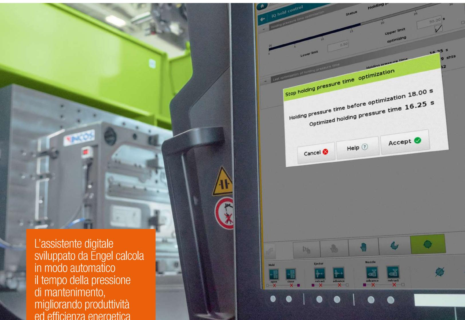
L'assistente digitale sviluppato da Engel calcola in modo automatico il tempo della pressione di mantenimento, migliorando produttività ed efficienza energetica
