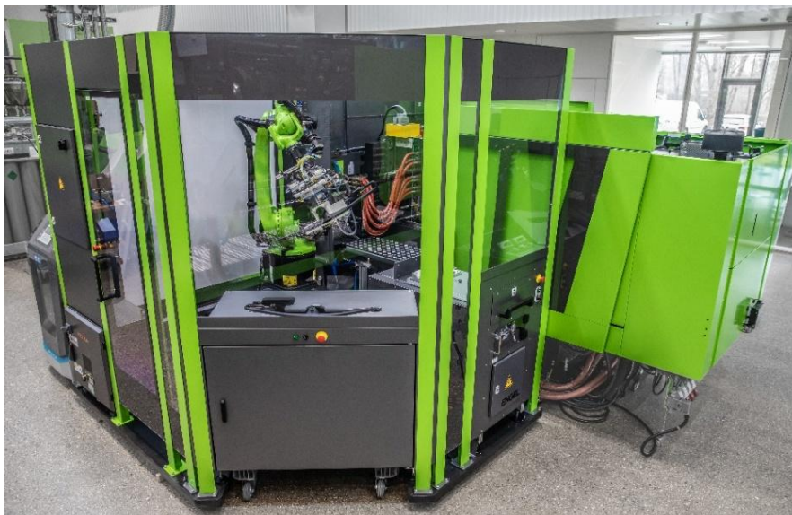
Figura 1: La cella di produzione altamente integrata sviluppata da ENGEL per lo stampaggio di un innovativo manubrio per bicicletta di CANYON Bicycles - live a EUROBIKE, Padiglione 8, Stand N04. Immagine ENGEL
