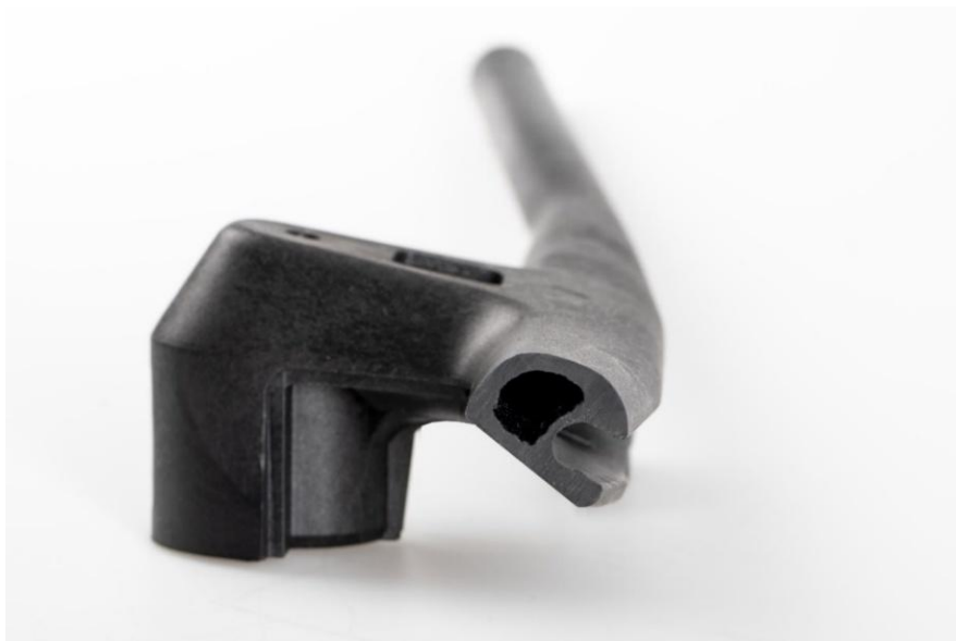
Figura 3: Il processo ENGEL fluidmelt permette di produrre componenti cavi con eccezionale libertà di design. Nell'immagine: la sezione trasversale del manubrio/cockpit per bicicletta che mostra lo spazio per l'integrazione dei cavi. Immagine: ENGEL
