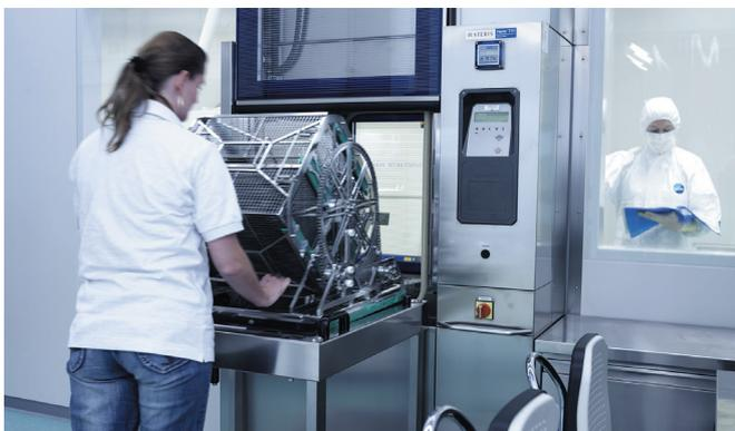
Рис. 2. Иглы для фиксаторов ZipFix транспортируются в чистое помещение с литьевой машиной непосредственно из системы их предварительной промывки в воде высокой степени чистоты и сушки (источник рис. 2–4: Samarplast)
