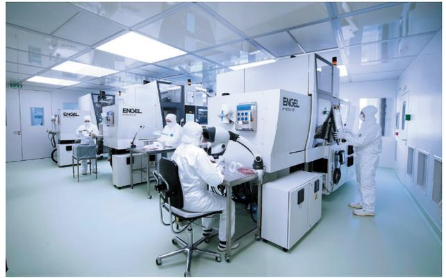
Первая бесколонная машина была поставлена на Samarplast еще в 1990 г., а затем этот тип литьевого оборудования, получив заслуженное признание, стал преобладающим в компании (источник: Samarplast)
