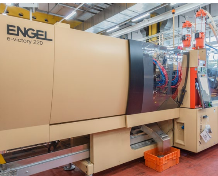
Wtryskarka e-victory 220 przeznaczona jest wyłącznie do produkcji obudów cylindrów amortyzatorów.
