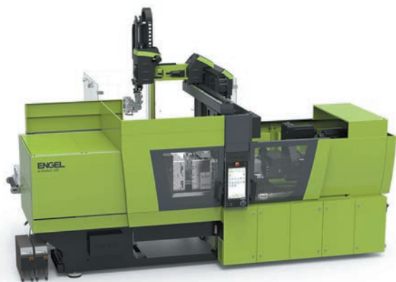
Рис. 4. Полностью электрическая литьевая машина ENGEL e-motion 310/120 TL, на которой изготавливались демонстрационные световоды
