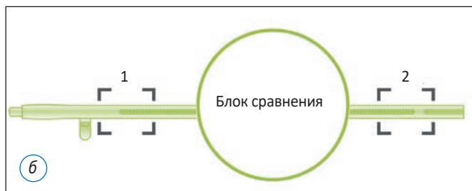
Рис. 5. Встроенная система контроля качества световода (а), основанная на сравнении значений T_{\text{кц}} , измеряемых рядом с источником света (1) и на расстоянии от него (2) (б)
