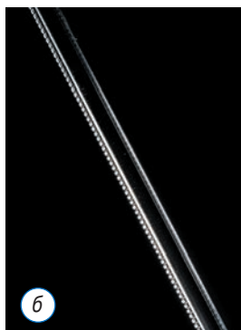
Рис. 1. Демонстрационные образцы световодов из ПММА (а), в одной из частей которых имеются филенчатые структуры, предназначенные для расщепления светового потока на выходе из световода (б) (все рисунки: ENGEL)
