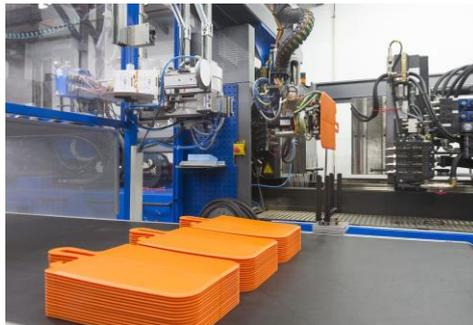
Da keine Holme im Weg sind, kann der Arm des ENGEL viper Roboters direkt von der Seite aus in den Werkzeugraum gelangen.
