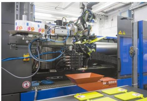
Die Angüsse werden bei Koziol zu 100 Prozent recycelt. Dank Holmlostechnik passt die Schneidmühle platzsparend zwischen Schließeinheit und Austaktband.
