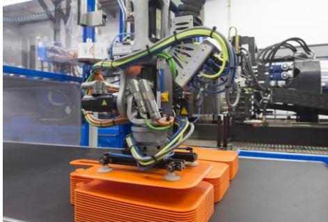
Nach der Kamerakontrolle stapelt der ENGEL viper Roboter die Küchenbrettchen auf dem Austaktband.
