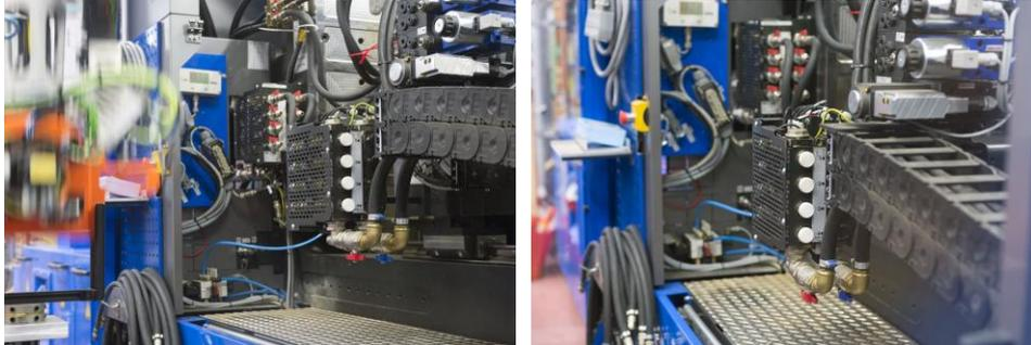
Da der Temperierwasserverteiler flomo besonders kompakt baut, lässt er sich sehr nah am Werkzeug montieren und minimiert so die Wärmeverluste.
