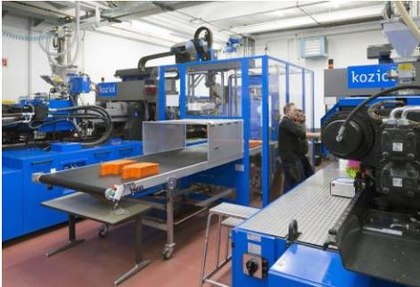
Trotz der niedrigen Halle konnten die beiden neuen ENGEL victory 400 Spritzgießmaschinen mit einem Standardroboter ausgestattet werden. Die Fertigungszellen wurden von ENGEL als integrierte Systemlösungen aus einer Hand geliefert.
