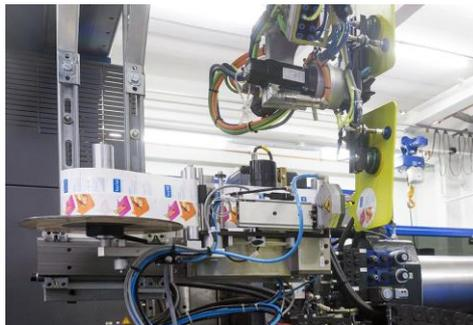
Aufkleber statt Umverpackung: Das Etikett wird unmittelbar nach dem Spritzgießprozess automatisiert aufgebracht.
