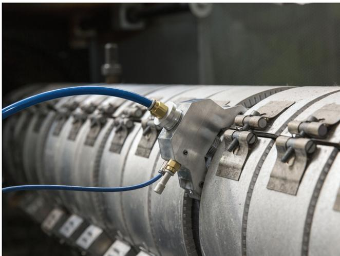
Фото 1. Новая измерительная УЗ-система без осложнений может быть смонтирована на внешней стороне материального цилиндра, как это показано на примере бесколонной машины с усилием смякания 5000 кН, установленной на предприятии компании Praher Plastics Austria (все иллюстрации: ENGEL)
