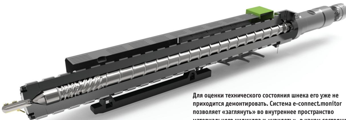
Для оценки технического состояния шнека его уже не приходится демонтировать. Система e-connect.monitor позволяет «заглянуть» во внутреннее пространство материального цилиндра и «увидеть», в каком состоянии находится шнек
