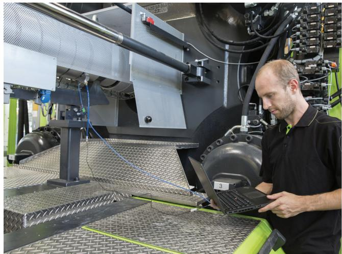
Фото 2. Для получения необходимых данных о состоянии шнека – в данном случае на машине модели ENGEL duo 16050/1700, оснащенной шнеком с диаметром 135 мм и установленной на предприятии компании Schoefer – требуется несколько минут. Результаты измерений анализируются автоматически
