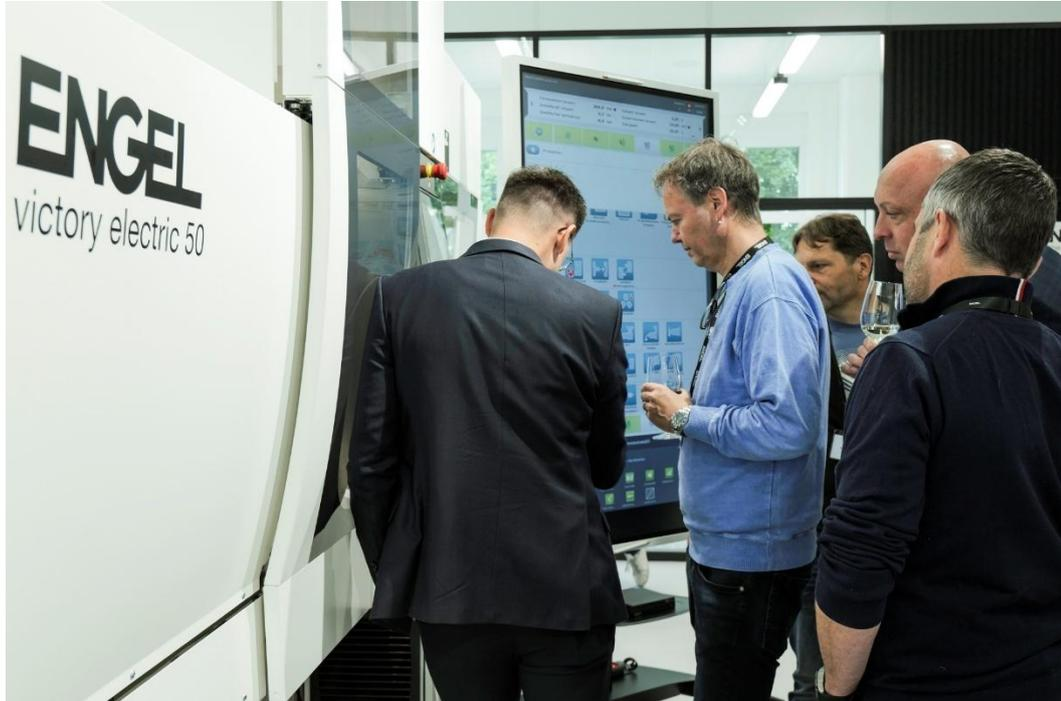
*Image 4: Le Centre Technique en Suisse fait également office de centre de compétences médicales. Ici, les visiteurs voient une presse à injecter électrique sans-colonnes, la victory electric, avec un équipement de salle blanche.*
