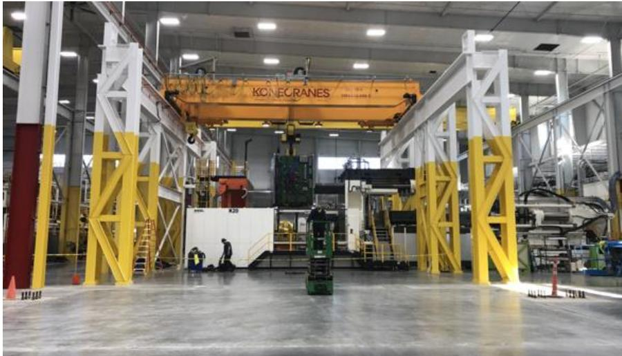
Le pont roulant de 135 tonnes de l'usine d'Infiltrator ne sert pas qu'au montage des moules. Il a également été utilisé pour l'installation des nouvelles machines de gros tonnage. (Photo : ENGEL)
