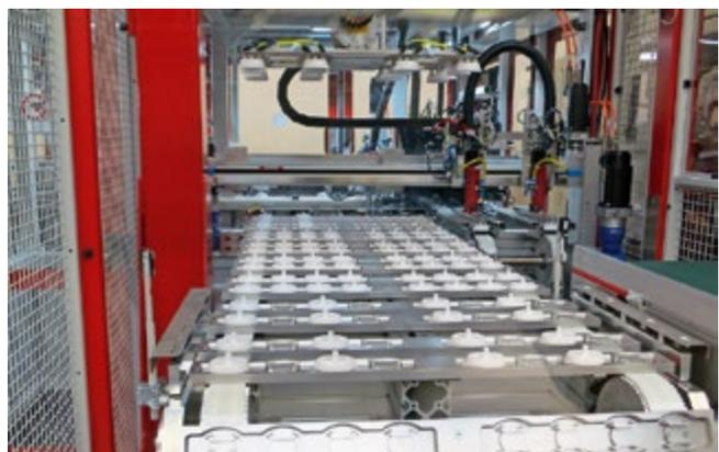
Der Roboter übergibt die Gehäuseteile aus dem Werkzeug direkt an die Qualitätskontrolle, die platzsparend an der Rückseite der Spritzgießmaschine angeordnet ist.
