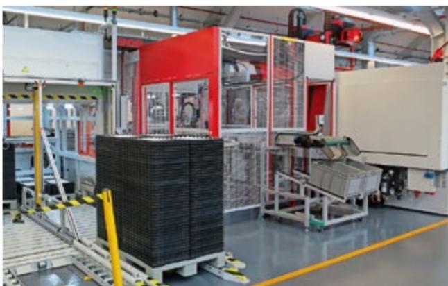
Eine holmlose Victory Spritzgießmaschine mit integriertem Viper 60 Doppelroboter bildet das Herz der Fertigungszelle.
