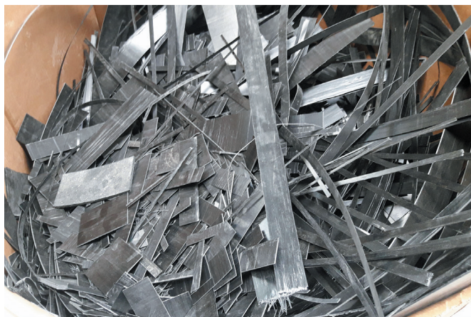
Рис. 1. Регранулят для испытаний (справа) был получен из обрезков органолистов на основе армирующих однонаправленных лент (слева) (источник: PureLoop)
