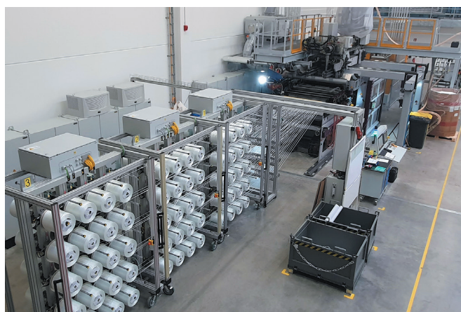
Рис. 2. Линия компании Profol для производства стекловолоконистых ПП-органолитов, использованных для последующих испытаний (источник: Profol)
