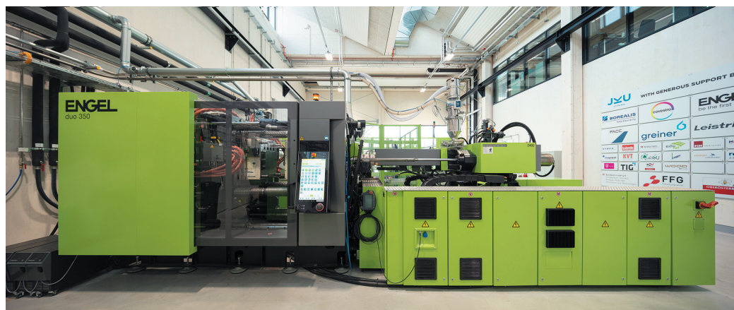
Рис. 4. Полностью автоматизированная производственная ячейка на базе литейной машины ENGEL duo 350, расположенная на заводе LIT в г. Линце, на которой в рамках интегрированного процесса были изготовлены близкие к серийным изделия с использованием регранулята из отходов органолистов (источник рис. 4, 5: ENGEL)
