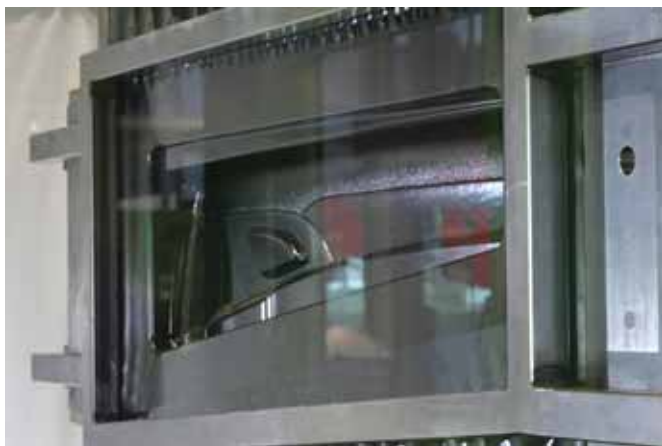
Фото 5. Во время нагрева начинается процесс штамповки пленки (на фото имеет черный цвет), которая при этом под воздействием создаваемого вакуума втягивается в форму для ее последующего структурирования
