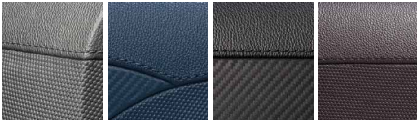
Фото 1. Материалы для технологии DecoJect были разработаны специально для применения во внутреннем пространстве транспортных средств. Они позволяют переносить на поверхность изделий различные структуры, а также цветовые и тактильные эффекты, включая текстуру кожи, швы и имитирующий углеродные материалы внешний вид (все фото: ENGEL)
