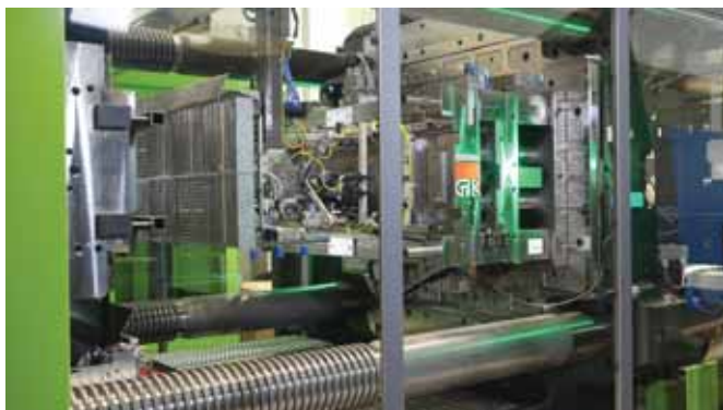
Фото 4. ИК-излучатель с несколькими зонами нагрева пленки интегрирован в захват линейного робота
