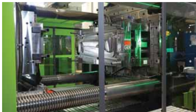
Фото 3. Литьевая форма, в которой в процессе текстурирования по методу In-Mould Graining пленка приобретает требуемую поверхностную структуру
