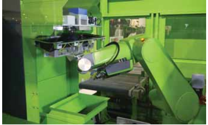
Фото 6. При изготовлении изделий по технологии DecoJect многоосевой робот и лазерная станция для обрезки пленки интегрируются в автоматизированную установку easiCell (слева). Робот перемещает край изделия вдоль лазера (справа), а затем укладывает готовое к использованию изделие на транспортирующую ленту
