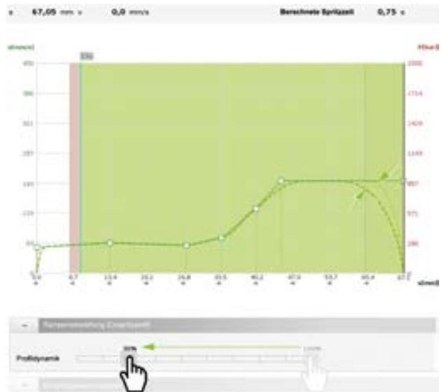
Bild 1: Der vorberechnete Geschwindigkeitsverlauf (gestrichelt) zeigt den erwarteten Geschwindigkeitsverlauf, basierend auf den eingestellten Sollwerten. Mit dem Ändern der Profildynamik lässt sich die Bewegung sanfter oder dynamischer einstellen. Die Auswirkung wird direkt während der Bewegung des Schiebereglers sichtbar.
