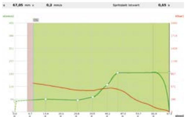
Bild 2: Die grafische Darstellung in der CC300 zeigt auf einen Blick alle wichtigen Informationen. Der Einspritzverlauf wird entsprechend der Bewegungsrichtung der Schnecke von rechts nach links dargestellt. Die grünen Linien stellen die Geschwindigkeitskurven dar und die rote Linie die Druckkurve.
