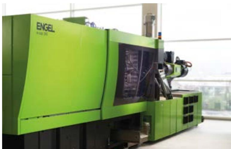
Ab sofort rüstet ENGEL alle Spritzgießmaschinen mit elektrischen Spritzaggregaten mit einer optimierten Sollwertberechnung für den Einspritzgeschwindigkeitsverlauf aus.
