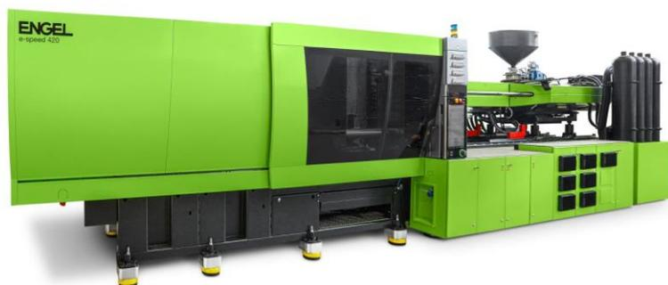
Las máquinas de moldeo por inyección ENGEL e-speed con unidad de inyección híbrida y unidad de cierre eléctrica combinan ciclos muy breves, máxima precisión y velocidades de inyección muy altas con una extraordinaria eficiencia energética. Como novedad, ENGEL presentará en la feria Fakuma 2021 la e-speed 420 con 4200 kN de fuerza de cierre. (Imagen: ENGEL)
