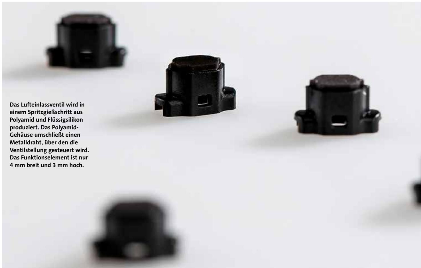
Das Lufteinlassventil wird in einem Spritzgießschritt aus Polyamid und Flüssigsilikon produziert. Das Polyamid-Gehäuse umschließt einen Metalldraht, über den die Ventilstellung gesteuert wird. Das Funktionselement ist nur 4 mm breit und 3 mm hoch.
