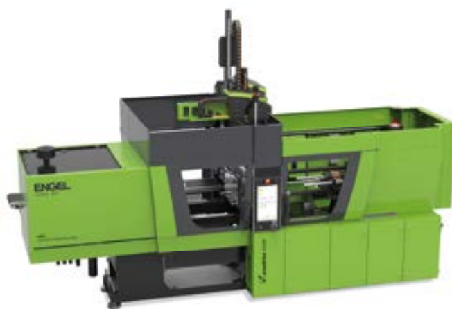
Na bazie cieszącej się uznaniem hydraulicznej, bezkolumnowej serii victory ENGEL opracował nową wtryskarkę do przetwarzania metali amorficznych.
