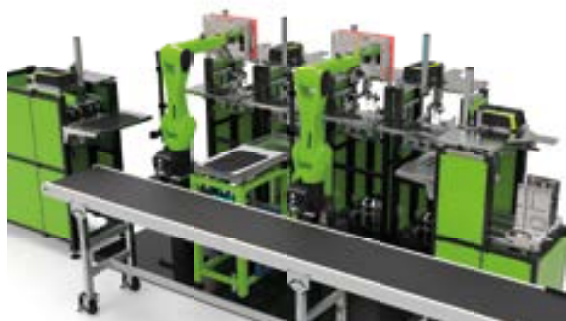
Opracowana przez ENGEL komora układania taśm wykorzystuje technikę kamer wysokiej rozdzielczości do produkcji precyzyjnych stosów z odcinków taśmy.
