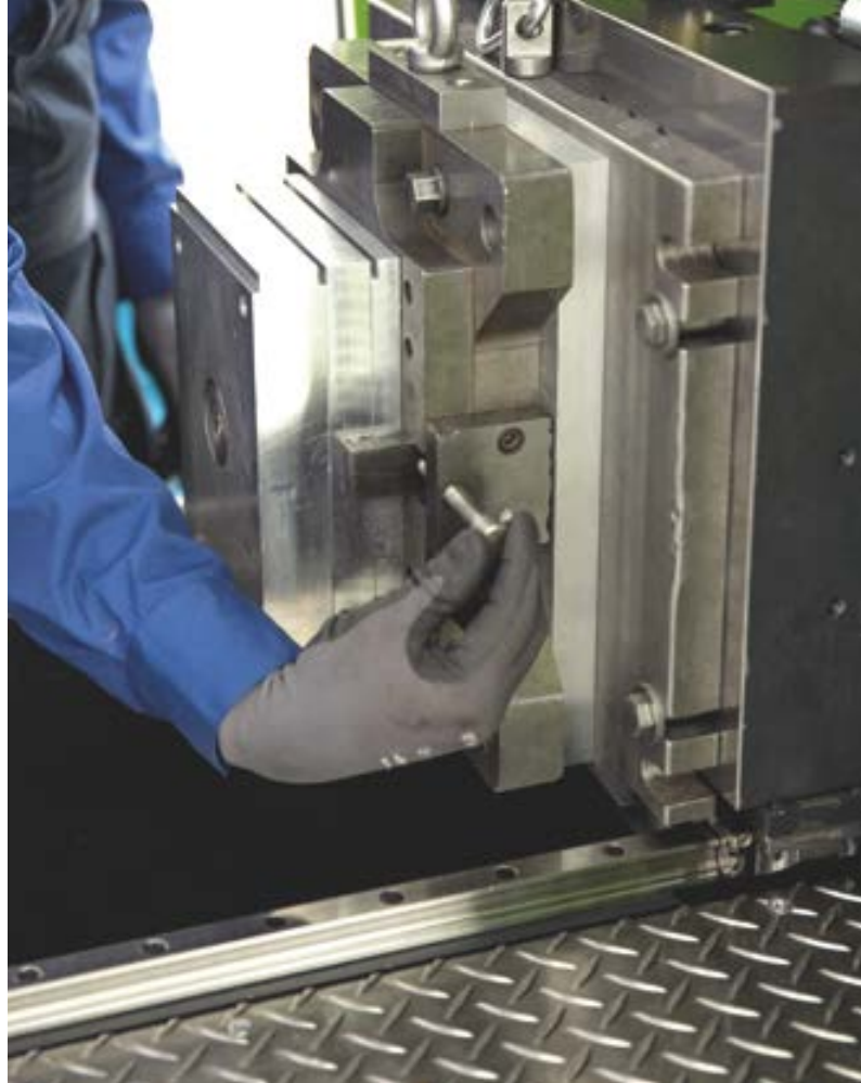
Dzięki technologii bezkolumnowej i wymiennym wkładom przebrojenie zajmuje mniej niż pięć minut.
