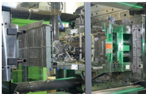
**3** Gli elementi a infrarossi che riscaldano il film per IMG sono integrati nelle pinze del robot lineare
