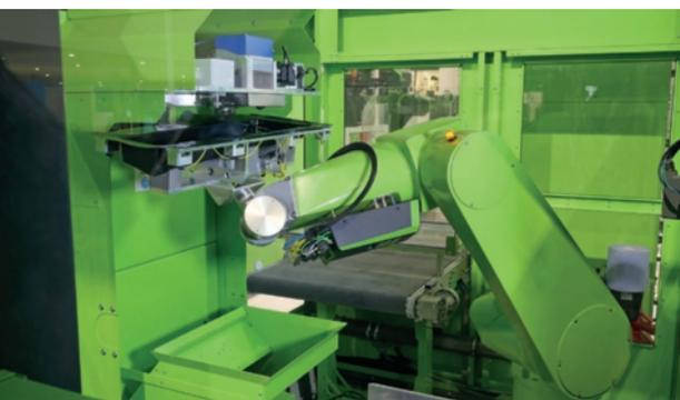
**6** Per il processo DecoJect, la cella di automazione easiCell (a sinistra) integra un robot multiasse e una stazione laser per la rifilatura del manufatto dimostrativo. Il robot muove il profilo del componente lungo il raggio laser (a destra), e posiziona il manufatto pronto all'uso sul nastro trasportatore
