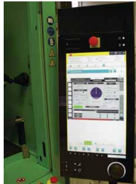
С помощью системы управления CC300 вертикальной машиной ENGEL insert можно независимо от количества модулей в производственной ячейке визуализировать весь технологический процесс изготовления металлополимерных изделий и управлять им
