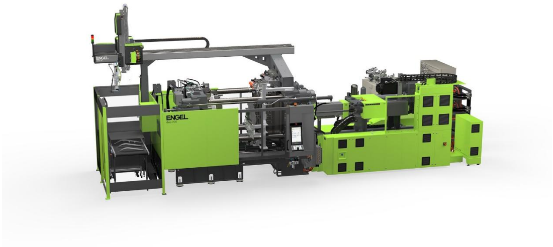
Image 1 : Les feux arrière « fonctionnalisés » sont produits sur une ENGEL duo 700 – de haute précision et utilisant clearmelt et foilmelt dans un processus intégré unique avec une empreinte au sol compacte.
