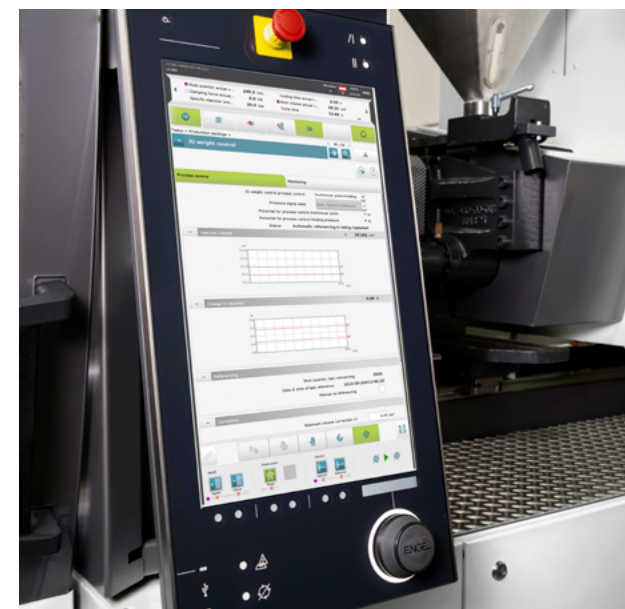
图 4：注塑机的控制系统越来越智能化。借助 iQ weight control 等辅助系统，注塑流程能够不断进行自我调节
