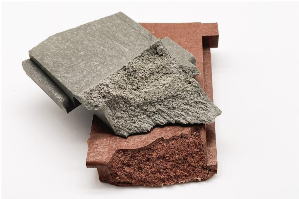
Bild 2: Leicht, stabil, nachhaltig: Querschnitt durch das perfekt geschäumte Bauteil aus 100 Prozent Post-Consumer-Rezyklat überzeugt mit 30 Prozent weniger Gewicht und 10 Prozent höherer Schlagfestigkeit.
