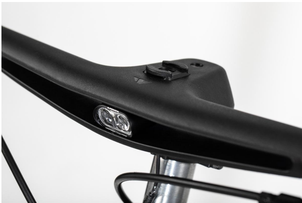
Imagen 2: El nuevo manubrio de bicicleta para CANYON Bicycles es robusto, ligero y funcional: este manubrio producido mediante el sistema de ENGEL, que sustituye por completo la anterior solución de aluminio, se fabrica en un ciclo muy corto, pesa casi un 15% menos y amortigua mejor las vibraciones.
