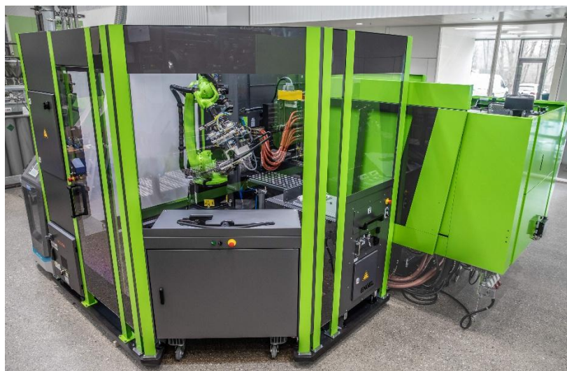
Zdjęcie 2: Robot easix w działaniu: sześćoosiowe roboty ENGEL easix wyróżniają się wysoką elastycznością i kompaktowym designem – są idealne do kompleksowych zadań automatyzacyjnych w ograniczonej przestrzeni.
