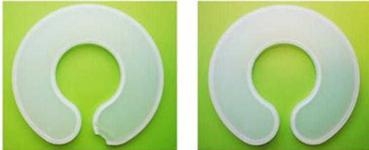
Links ohne, rechts mit iQ weight control: Die Software erkennt automatisch Schwankungen im Rohmaterial und gleicht sie noch im selben Zyklus automatisch aus.
