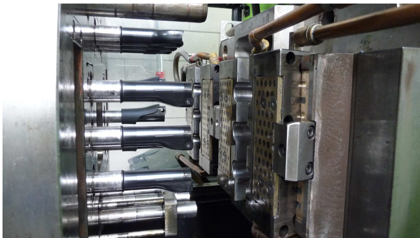
Der Drehtisch für das ENGEL combimelt-Verfahren hat bei Widek vier Positionen. (Bild: ENGEL Austria)
