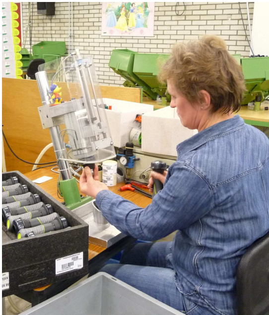
Aus drei Komponenten montiert die Mitarbeiterin die neuen Fahrradgriffe mit integrierter Klingel und testet ihre Funktionsfähigkeit. (Bild: ENGEL Austria)
