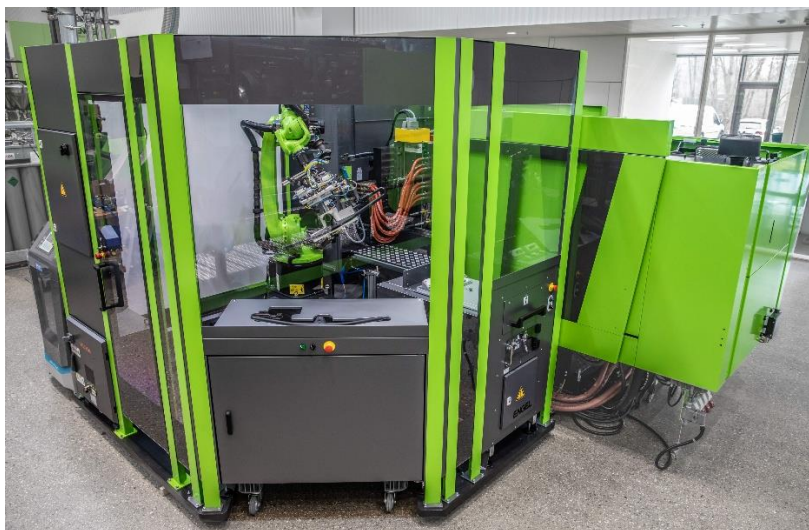
Obrázek 2: Robot easix v akci: Šestiosé roboty ENGEL easix vynikají vysokou flexibilitou a kompaktní konstrukcí – ideální pro složité automatizační úlohy ve stísněných prostorech.
