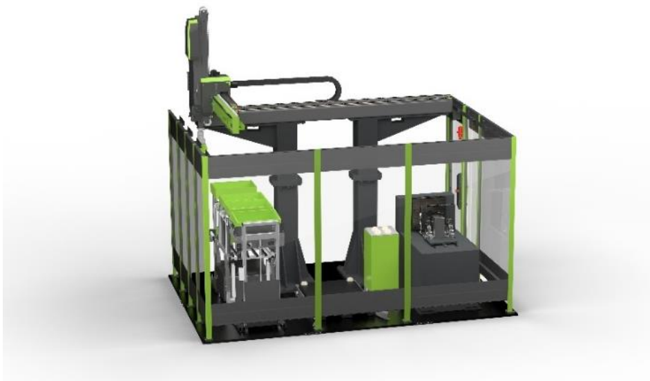
Obrázek 1: Koutek pro odborníky s viperem 20 nové generace a automatickým překládáním boxů: Na veletrhu K 2025 ukazuje společnost ENGEL flexibilitu nových lineárních robotů viper s rozšířeným pracovním rozsahem a víceúrovňovým přenosem boxů s nízkými vibracemi – prostorově úsporné a vysoce flexibilní řešení pro efektivní výrobní procesy.
