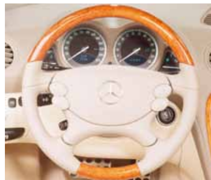
Фото 1. Технология clearmelt позволяет экономично изготавливать декоративные изделия из натуральной древесины (фото: Votteler)
