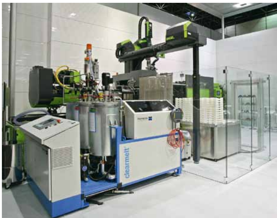
Фото 3. В составе производственной ячейки объединены литьевая машина и система подготовки уретановой композиции, работающая под высоким давлением. Специализирующаяся в области переработки ПУ компания Henneske является эксклюзивным партнером компании ENGEL при реализации проекта (фото: ENGEL)
